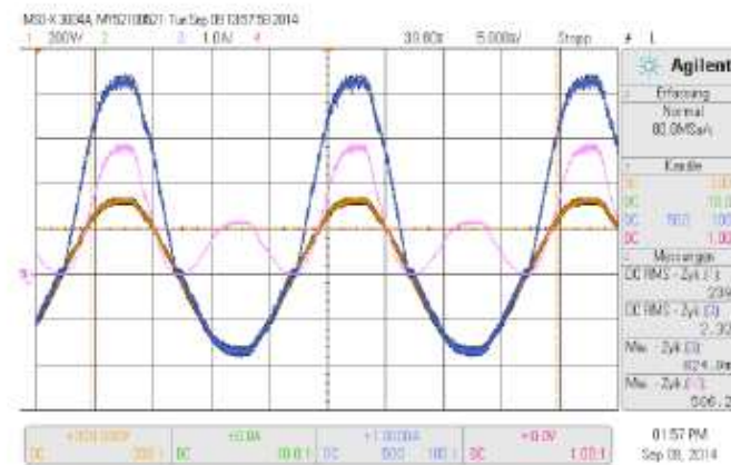
Abbildung 4-60: Föhn; Spannung (gelb), Strom (blau), Leistung (pink); Wärme 1 & Gebläse 2
